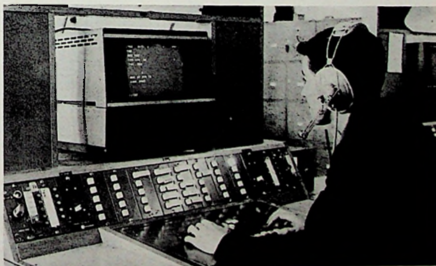
Opleiding van luchtverkeersleiders met behulp van geavanceerde elektronische apparatuur. Deze simulator kan het aanvliegen van 40 tot 80 vliegtuigen in de betreffende sector nabootsen.
