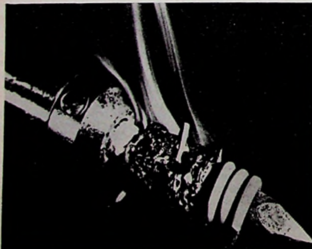
Afb. 4. De bestendigheid van PTFE-harsen tegen de hitte van een soldeerbout wordt hier geïllustreerd. Het „Teflon” PTFE-hars wordt in het geheel niet aangetast terwijl de twee andere isolaties door de hitte worden verkoold.
